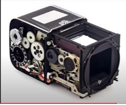
Feine Zahnräder verbiegen sich bei solchen Temperaturunterschieden.
