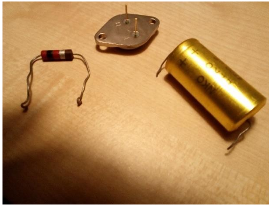
Technik der 60er Jahre: Widerstand, Transistor, Kondensator. Für einen Rechner braucht es mehrere 100000 davon.
